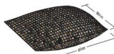
Figure 21 : Pochon en PEHD remplis de galets
